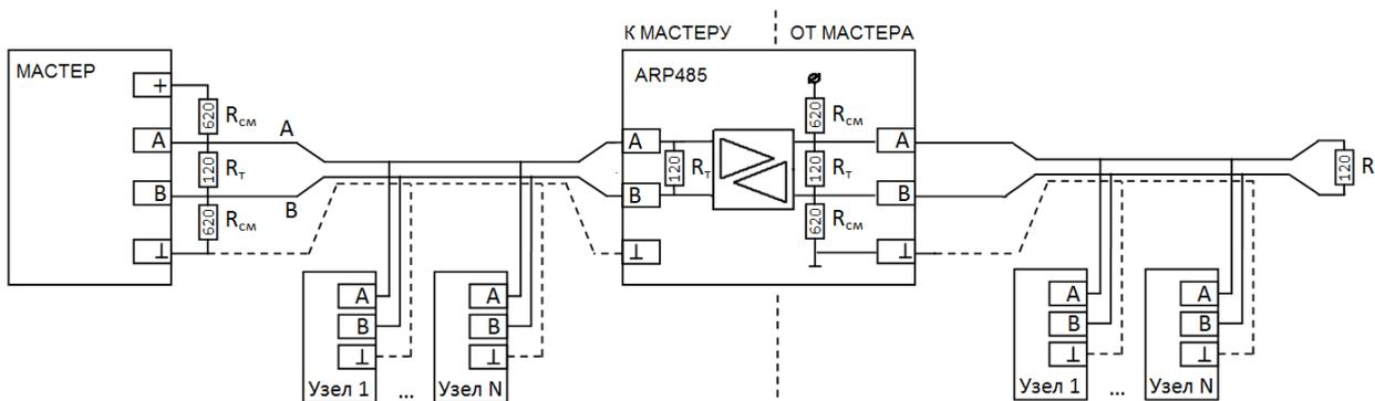
Рисунок 3. Схема подключения ARP485
